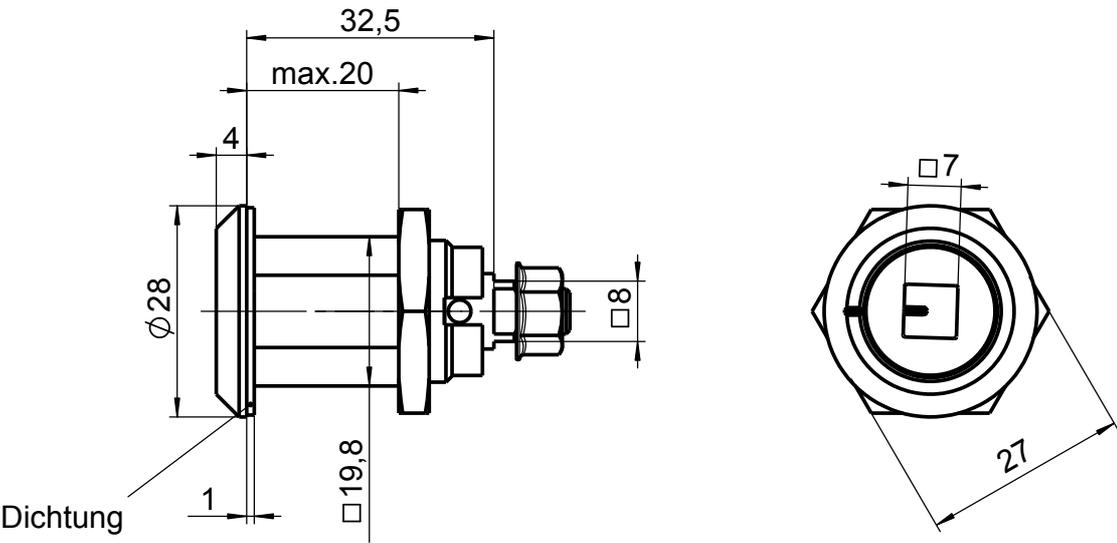
Gehäuse und Einsatz Druckguss verchromt
